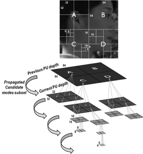
Fig. 7. HEVC PUs quadtree hierarchical structure
