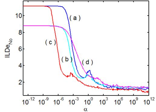
**Fig. 6.** Noise ILD error. Proposed technique: (a)  $S_0N_{-60}$ , (b)  $S_0N_{60}$ . Technique proposed in [4]: (c)  $S_0N_{-60}$ , (d)  $S_0N_{60}$ .
