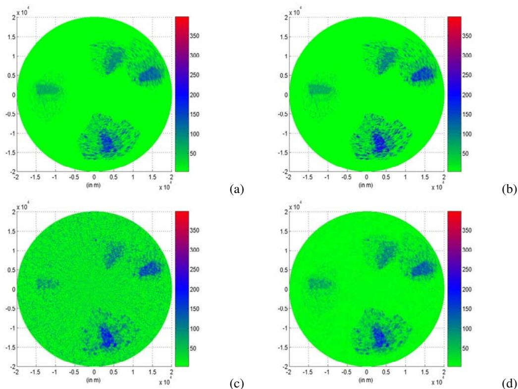
Figure 5: (a) Exact rain rate in  $\text{mm h}^{-1}$  (b)  $R(Z, Z_{dr})$  in  $\text{mm h}^{-1}$  (c)  $R(K_{dp}, Z_{dr})$  in  $\text{mm h}^{-1}$  (d)  $R(Z, K_{dp}, Z_{dr})$  in  $\text{mm h}^{-1}$ .
